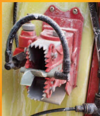
1 Vue détaillée du diffuseur pneumatique/jet porté réglable en ouverture et orientation.
