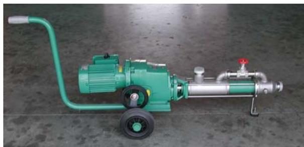
Pompe à rotor hélicoïdal (source : ITV)
