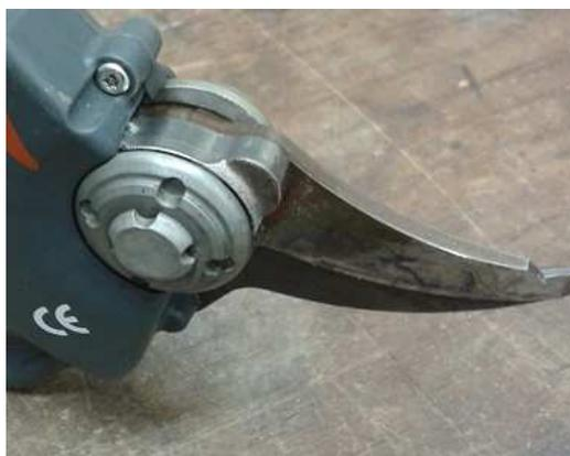
Tête de coupe équipée de roulements à billes radiaux et axiaux
