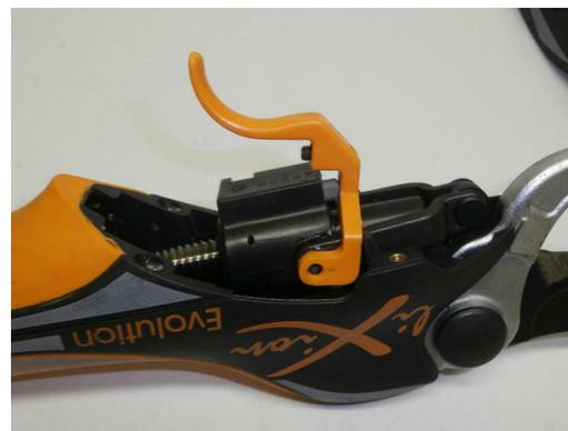
Système d'écrou et vis à billes
