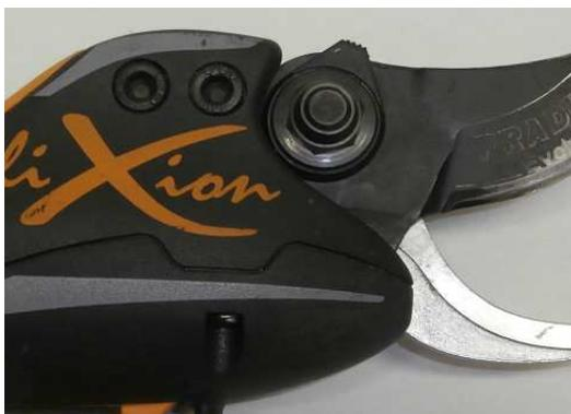
Nouvelle tête de coupe (avec rondelle de contrôle du serrage de la lame)
