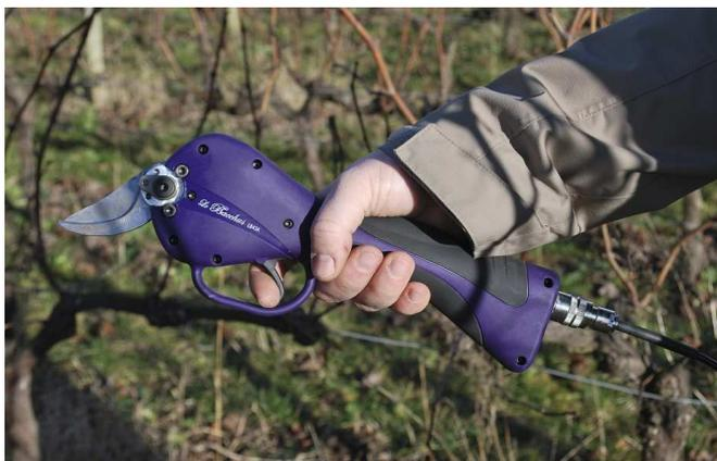
Pour cela, il suffit simplement de maintenir une pression sur la gâchette (la temporisation est d'environ 1,5 seconde). L'ensemble des connectiques est de type « push pull ».
