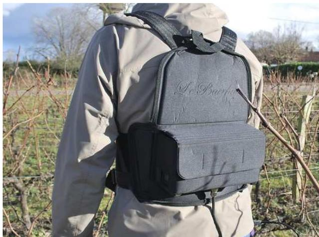
**Le portage** comporte une ceinture ventrale à velcros. Les bretelles sont réglables. Batterie et boîtier électronique sont installés en bas du portage. L'ensemble de la connectique se situe sous la batterie.
