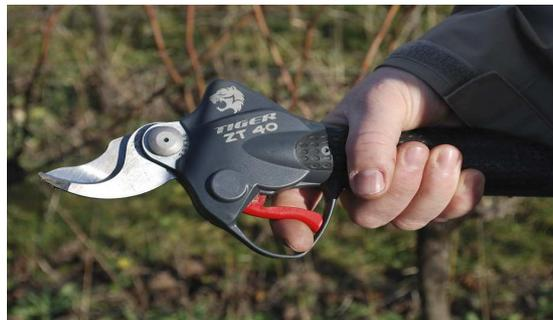
Cet équipement propose 2 modes d'ouverture de la tête de coupe : le mode « 1/2 ouverture » et le mode « ouverture maximum » qui permettent respectivement une ouverture de 20 ou 50 mm de la tête de coupe. La gestion de cette fonction s'effectue grâce à un maintien de pression sur la gâchette. La temporisation est d'environ 1 seconde.
