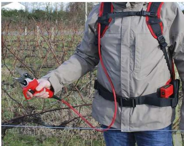
**La batterie** utilise désormais la technologie Lithium Polymère (Li-Po). Le fonctionnement est semblable aux batteries Lithium Ion (Li-ion) tout en permettant d'obtenir des batteries plus légères dans la mesure où le liquide électrolytique est remplacé par un polymère gélifié.
