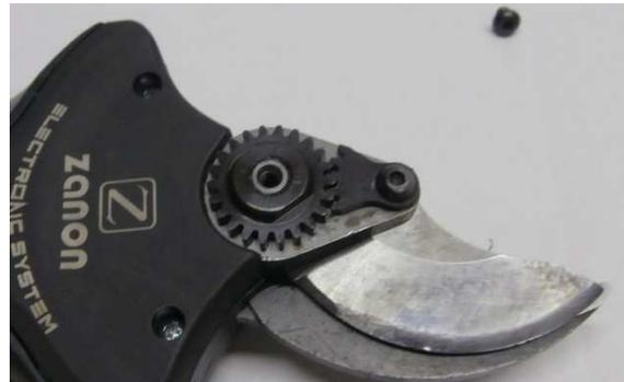
Contrôle du serrage de la lame
