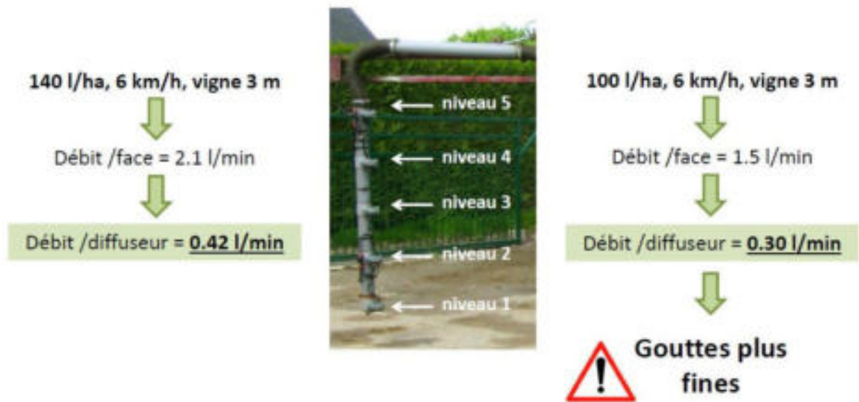
Source : Comparaison de débit pour un pulvérisateur pneumatique avec une pression différente
