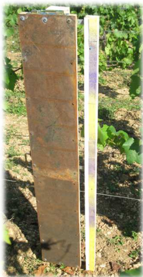
Plaque de fer rouillée et papiers hydro-sensibles
