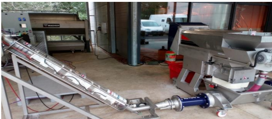
Photo 10 : Equipement pilote Champs Electriques Pulsés CEP – IFV 2018
