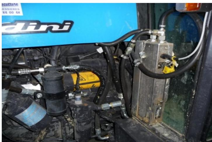
Photo 5 : Débitmètre gasoil monté sur tracteur pour mesure consommation
