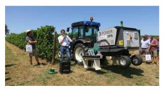
L'électricité provient d'une génératrice semi-portée qui fonctionne grâce à la prise de force du tracteur.
