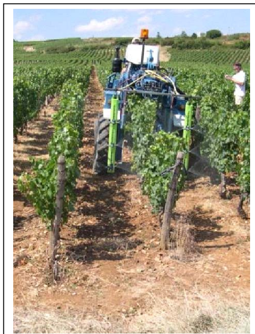
Photos n° 1 et 2 : utilisation de buses ATR (gauche) et TVI (droite) à pression et débit identiques
