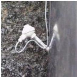
La sonde de température est de type RTD normalisé Pt 100 ou Pt 1000, plus rarement de type PTC ou Thermocouples. Elle doit pouvoir être étalonnée facilement à partir du système de régulation. Cet étalonnage doit être **impérativement** effectué avant chaque campagne sous peine d'avoir un décalage (parfois important) entre la température de régulation et la température souhaitée. Les sondes sont introduites dans la cuve par l'intermédiaire d'un « doigt de gant » en inox.
